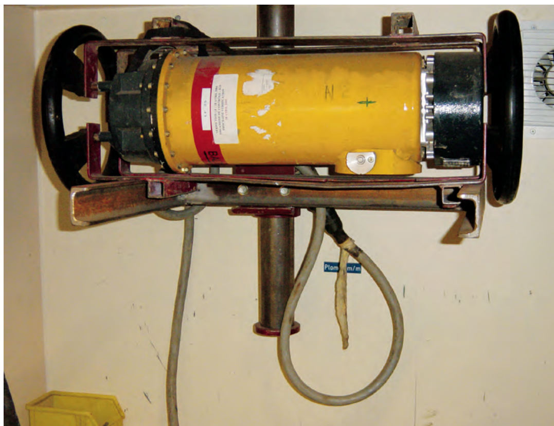
Générateur électrique de rayonnements X dans une enceinte de tir
