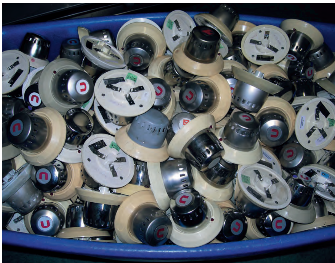
Détecteurs en phase de pré-démantèlement de la source d'americium
