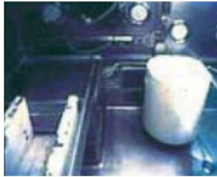
Fig. 24. Décontamination par gel de la cellule C2 (chaîne XEMO I) à l'Institut national des radioéléments (Fleurus/Belgique). État final.
