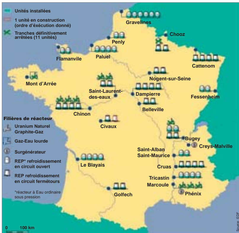
Fig. 5. Il existe 59 réacteurs en France, produisant une puissance électrique de 63 GWe. La France a remplacé par des REP tous ses réacteurs « graphite-gaz » de première génération.
