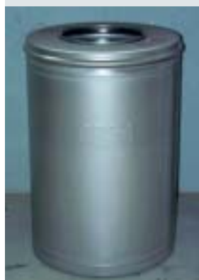
Fig. 69. Colis de déchets bituminés.
