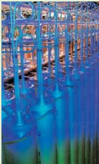
Fig. 18. Une cascade de centrifugeuses pour l'enrichissement de l'uranium.
