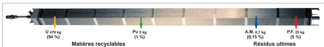
Fig. 13. Composition d'un assemblage de 500 kg d'uranium enrichi après son passage en réacteur.
