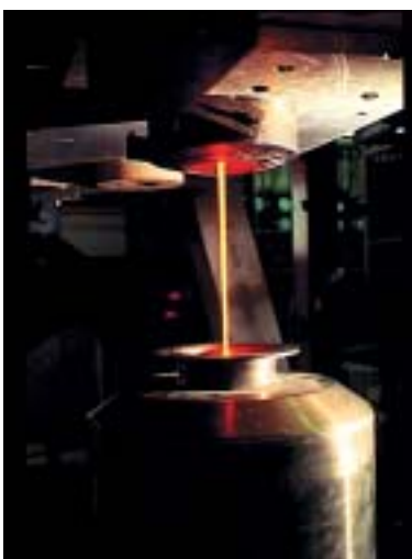
Fig. 71. Coulée de verre en laboratoire à Marcoule (Gard).
