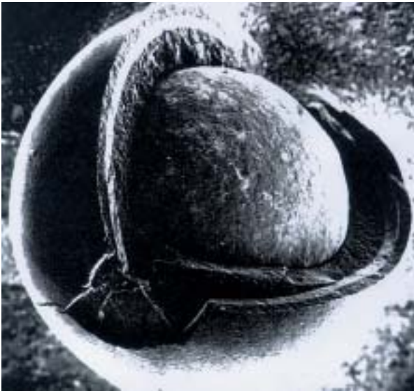
Fig. 101. L'utilisation d'un combustible à particule constitue l'innovation majeure des RHT. Le noyau de matière fissile ( UO_2 , PuO_2 , UC... ) est entouré de plusieurs couches successives en pelure d'oignon (pyrocarbone poreux ou dense, SiC ), destinées à assurer la protection du noyau fissile et le confinement des produits de fission. L'ensemble est réfractaire (pas de métal) et très résistant, ce qui permet de pousser ce combustible à très haute température et à très haut taux de combustion. Ce combustible a déjà été utilisé avec succès dans le passé. Il est possible d'améliorer encore ses performances par un choix judicieux de matériaux d'enrobage (tout n'a pas été exploré ; en particulier, le remplacement de la couche de SiC par du ZrC ouvre la voie des très hautes températures, de l'ordre de 1\ 000^\circ C ). Le CEA se dote actuellement d'une installation pilote pour la fabrication de ce type de combustible à particules (installation GAÏA, à Cadarache).
