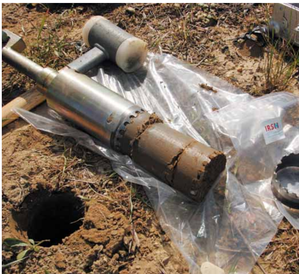
Échantillon de sol servant à la mesure des dépôts.
